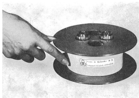
Fig. 12 Ligne à retard supraconductrice d'une microseconde Impulsion de temps de montée: 0,1 ns; Elargissement inférieur à 20 %; Atténuation: 0,2 dB
