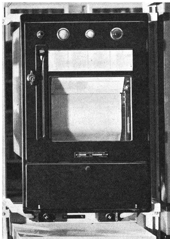
Fig. 4 Enregistreur de manœuvres et de signalisations
