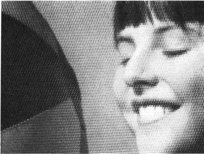
Fig. 13 Ausschnitt aus dem kompatiblen Schwarzweissbild beim PAL-System (1 Halbbild)
