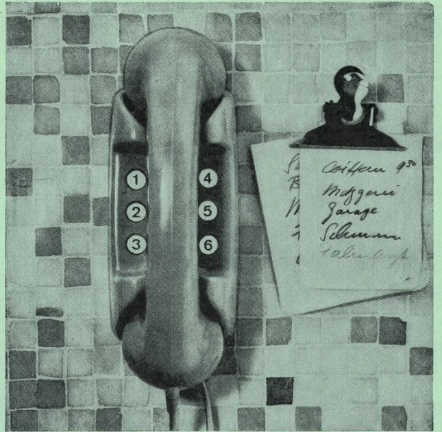
Haustelephon, ohne Amtsanschluss
