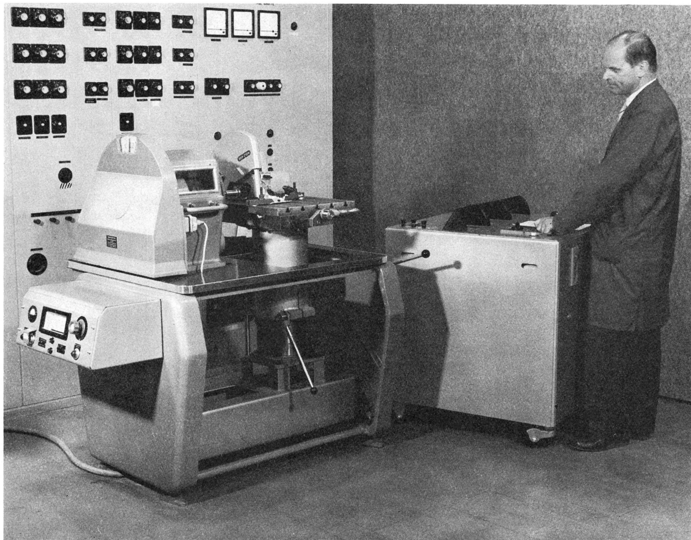
Prüfstand für schnellaufende Motoren und Elektrowerkzeuge
