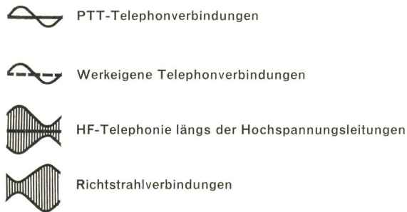
Fig. 7 Verbindungen der Elektrizitätswerke
