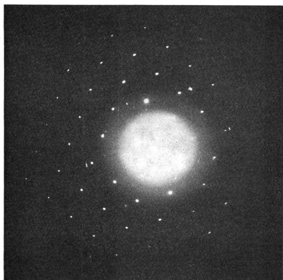
Fig. 4 Elektronendiffraktionsdiagramm Die Beugungsfiguren illustrieren die Wellennatur der Elektronenstrahlen
