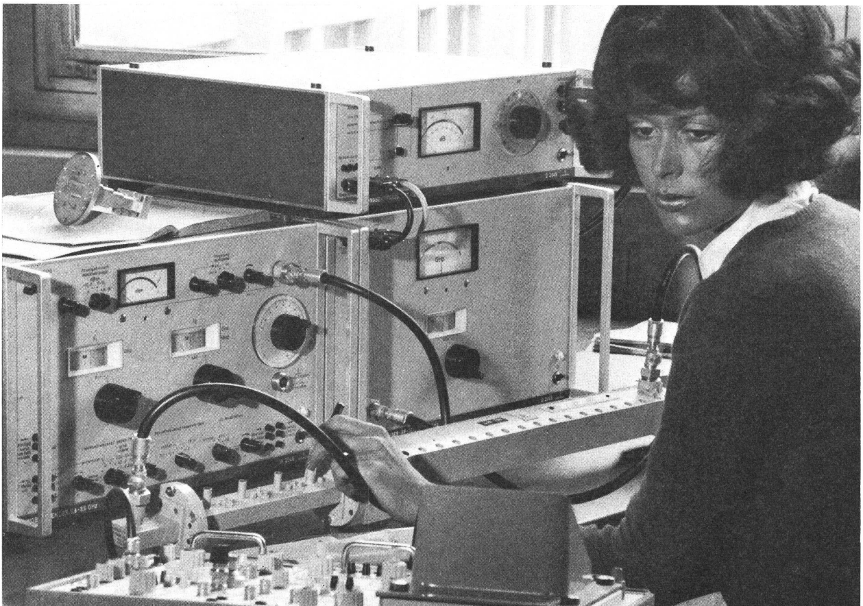
Abgleich eines Hohlleiterfilters mit einem Wobbelmessplatz
