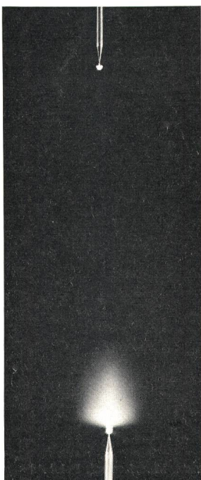
Fig. 17 Polaritätseffekt an einer Stab/Stab-Funkenstrecke bei hoher Gleichspannung Oberstab negativ, Unterstab positiv
