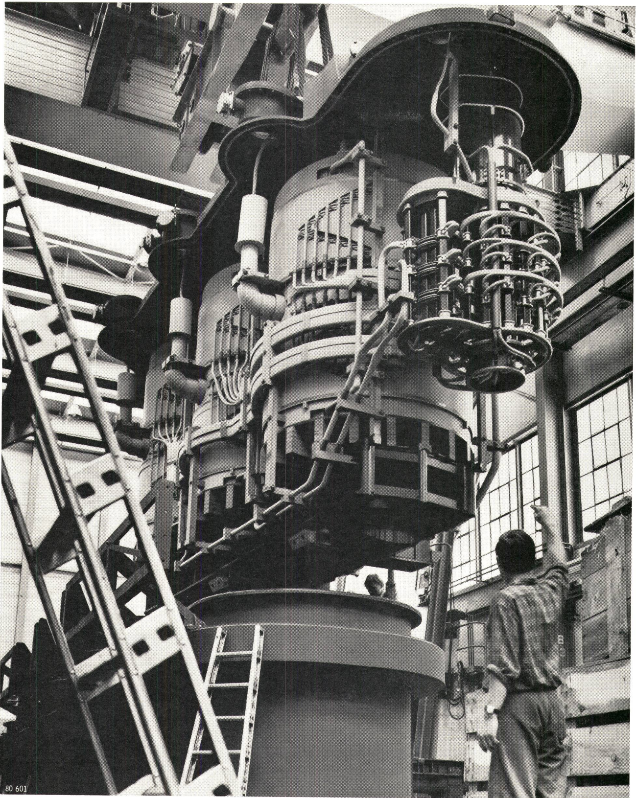
Montage eines 200 MVA Dreiphasen-Reguliertransformators, bestimmt für Vattenfallsverk, Anlage Bredåker (Schweden).
