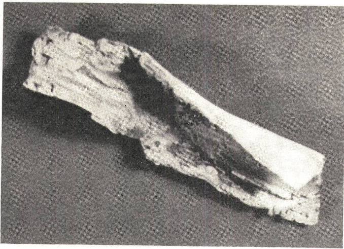
Fig. 6 Abgelöster Teil eines Erders aus verbleitem Kupfer
