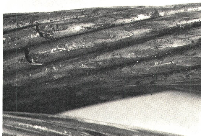
Fig. 5 Schwingungsbrüche und Druckellipsen
