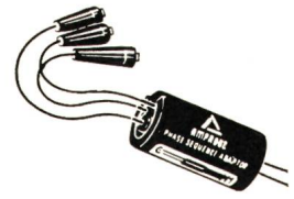
zur Prüfung der Phasenfolge
