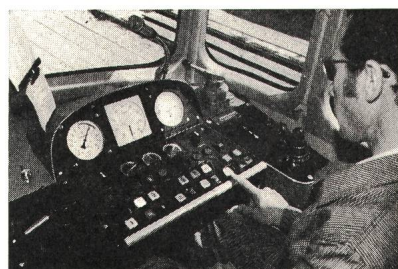
Fig. 4 Das Anzeigergerät der elektronischen Geschwindigkeitsmessanlage
