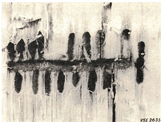
Fig. 8 Leiterstange einer Brutanlage des Nutzholzborkenkäfers.
