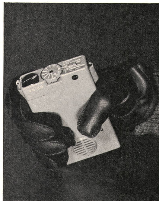
Fig. 1 Ein Verschütteten-Suchgerät nach dem Sender-Empfänger-Prinzip
