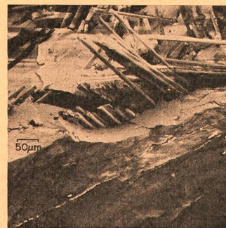
Fig. 10 Glasfaserverstärkter Kunststoff. Electro-Scan-mikroskopische Aufnahme
