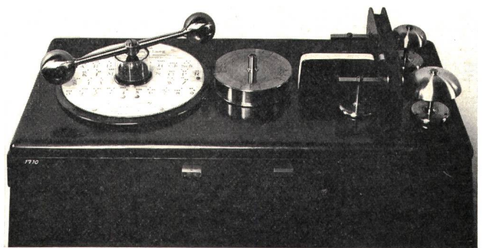
Fig. 14 1837: Erster galvano-magnetischer Schreibtelegraph nach Steinheil
