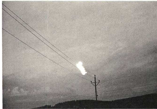
Fig. 7 Galvanischer Kurzschluss bei einem «scharfen» Wurf-Prüferdungs-Versuch auf einer 25-kV-Leitung, wie ihn das menschliche Auge (im Gegensatz zur Schnellbildkamera) wahrnimmt. (Aufnahme mit geringer Vorbelichtung)
