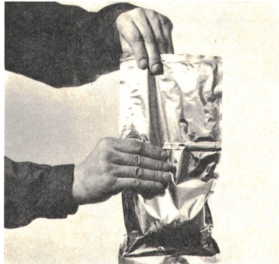
Fig. 6 Giessharz in Zweikammerbeutel
