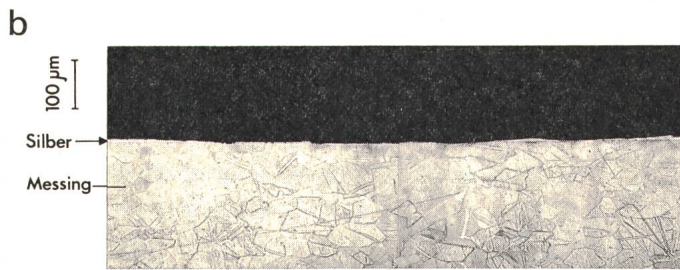
Fig. 5 Übergangsstelle eines versilberten (4 µm) Messingkontaktes eines Kontakteinsatzes nach 25 Mill. Schaltungen
