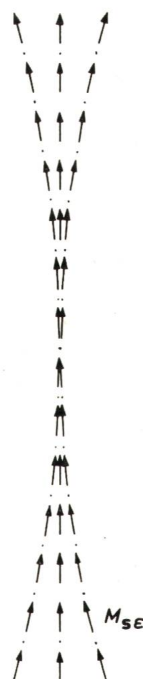
Fig. 31 Angenommener Verlauf der Streuung im Innern eines Magneten M_{s\varepsilon} Streugrössen eines Magnetteiles der Länge \varepsilon
