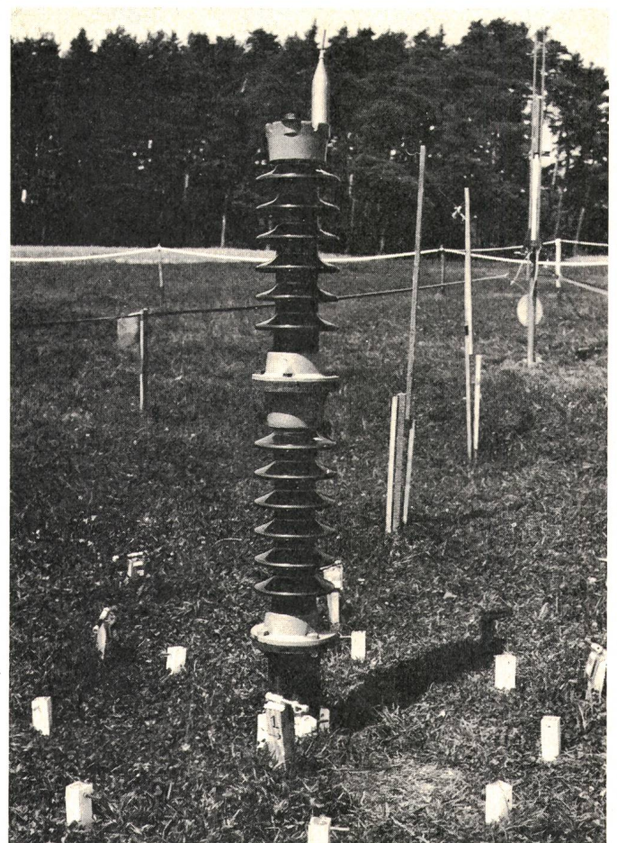
Fig. 4 Stützeranordnung des CEA mit Messproben und Triggereinrichtung
