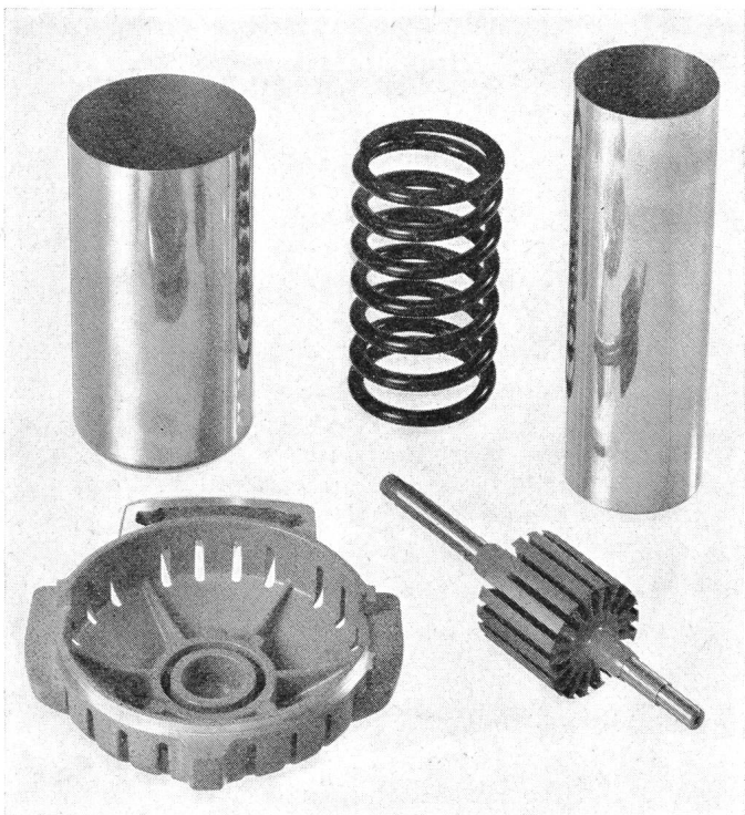
Fig. 11 Nach dem Gema-Verfahren pulverbeschichtete Objekte
