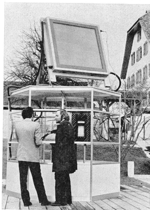
Fig. 1 Demonstrationsmodell eines Sonnenwärme-Kollektors
