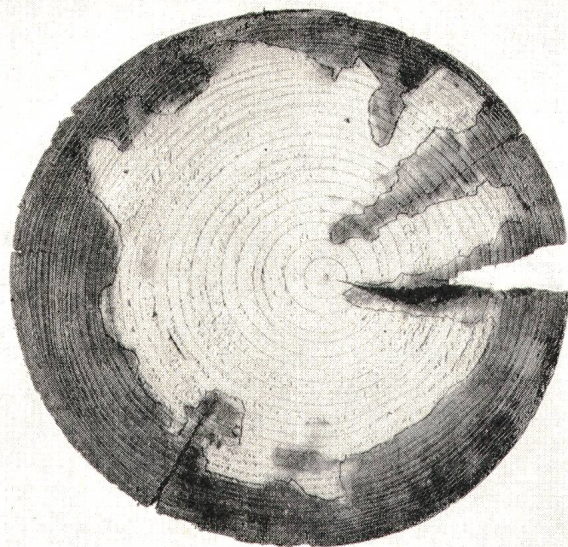
Fig. 7 Querschnitt eines im trockenen Zustand im Vakuum-Druckverfahren getränkten Mastes mit imprägnierten Schwindrissen. Die dunkle Zone ist vom Schutzmittel durchtränkt.
