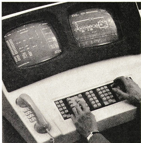
Fig. 6 Eingabetastatur und Bildschirme für Dialog und Anlagenschemadarstellung eines modernen ZLT-Systems (Werkfoto ITT Controls)
