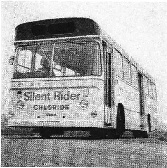
Fig. 5 Stadtbuss «Silent Rider», entwickelt von der Akkumulatorenfabrik Chloride in Zusammenarbeit mit SELNEC, einer britischen Transportunternehmung
