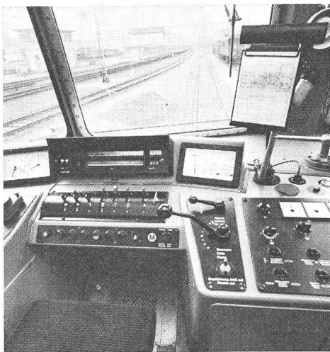
Fig. 9 Eingliederung des Anzeigerätes im Führerstand (Re4/4 II )
