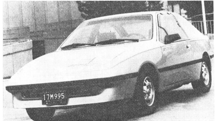
Fig. 1 Das elektrische Vier-Personen-Testauto ETV-1
