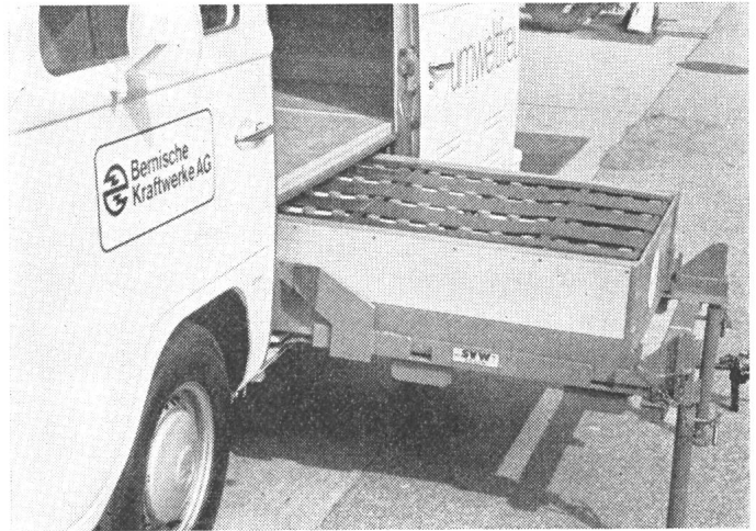
Fig. 2 Batterieeinschubeinheit des VW-Transporters der BKW
