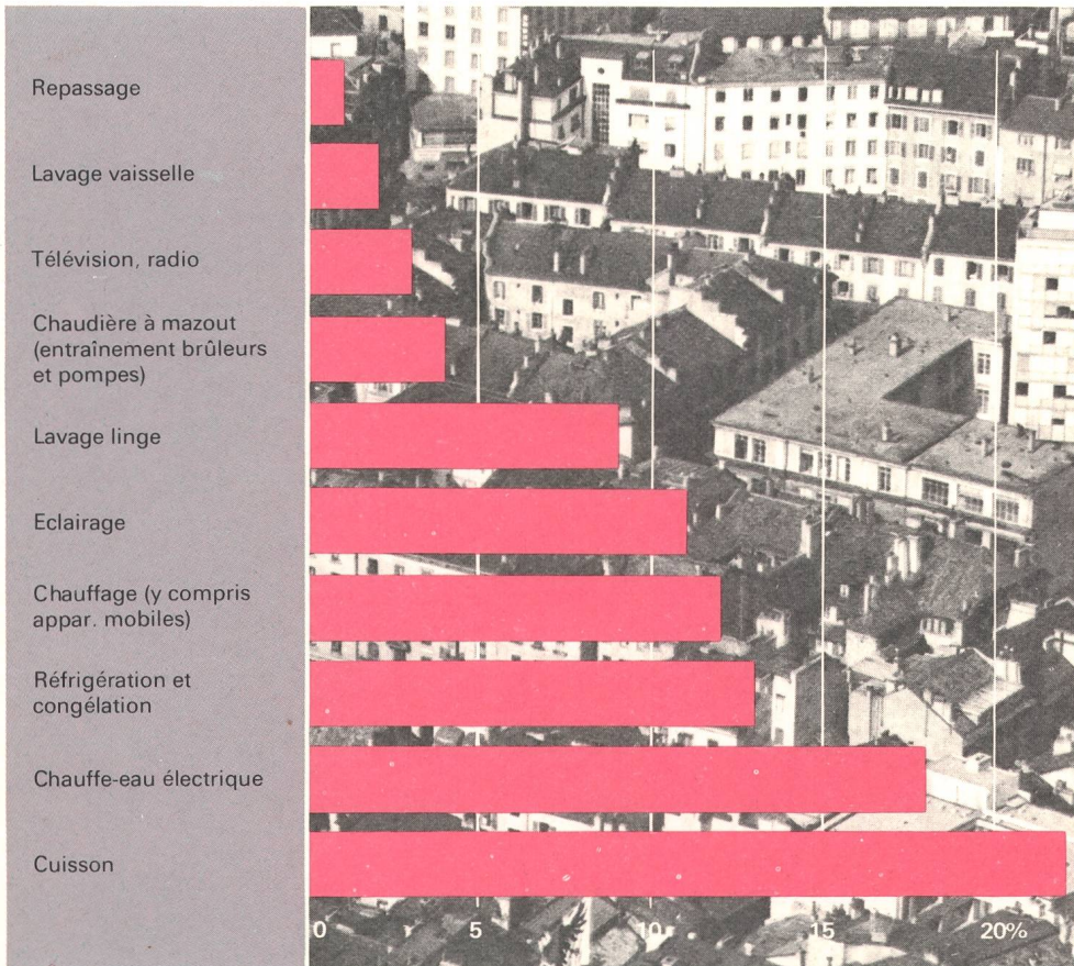
Part des principaux usages dans la consommation d'électricité des ménages
