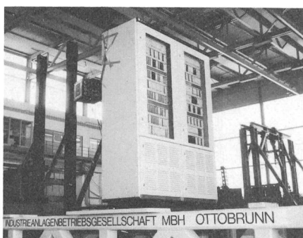
Fig. 4 Elektronikschränke mit gewichtsäquivalenter Baugruppenbestückung auf dem Rütteltisch (System MNS, BBC)
