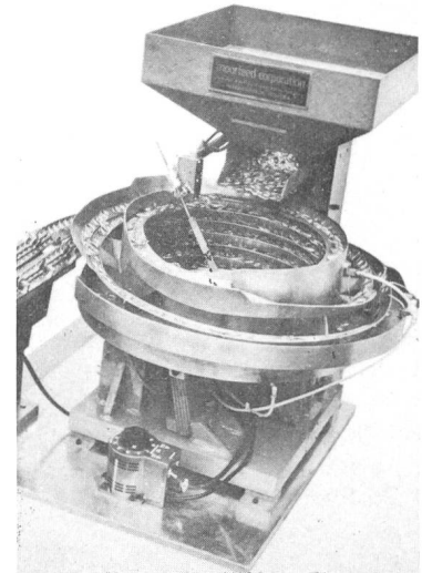
Fig. 2 Bol vibreur pour le positionnement de pièces stockées en vrac
