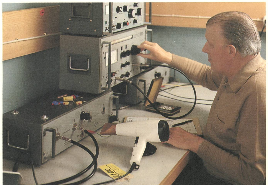
Radiostörschutzmessung an einem Haartrockner
