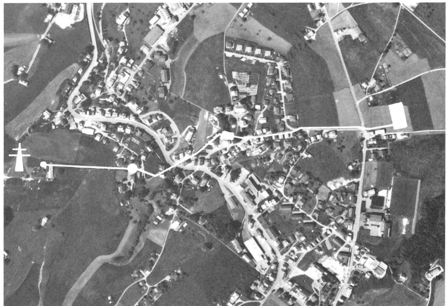
Fig. 3 Flugaufnahme mit eingetragener Kabeltrasse
