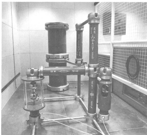
Fig. 9 Versuchsaufbau im Hochspannungs- praktikum mit pneumatischem Erdungsschalter und pneumatischer Funkenstrecke
