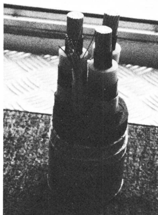
Fig. 1 Modell des verwendeten Seekabels
