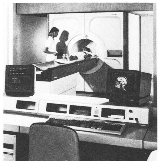
Fig. 3 Der Kernspintomograph Im Hintergrund der supraleitende Magnet mit der röhrenförmigen Patientenöffnung, vorn das Pult mit Bildmonitor, Textmonitor und Bedientastatur.
