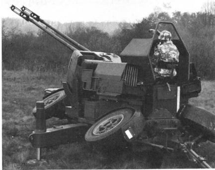
Fig. 1 Fliegerabwehrgeschütz mit Visier Gun-King
