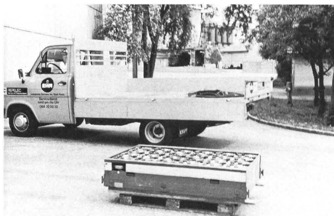
Fig. 5 Ein frisches Batteriepaket für den VW-Transporter steht zum Auswechseln bereit
