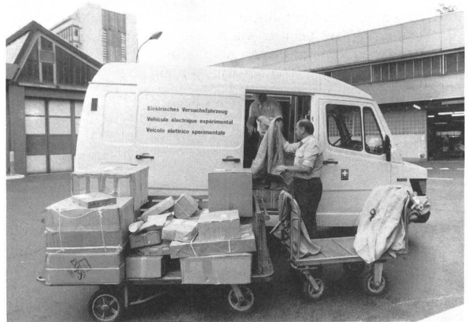
Le fourgon électrique expérimental est actuellement à l'essai aux PTT pour la distribution des colis en Ville de Berne.
