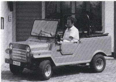
Das Elektro-Versuchsauto SWICEL in der Alltagserprobung
