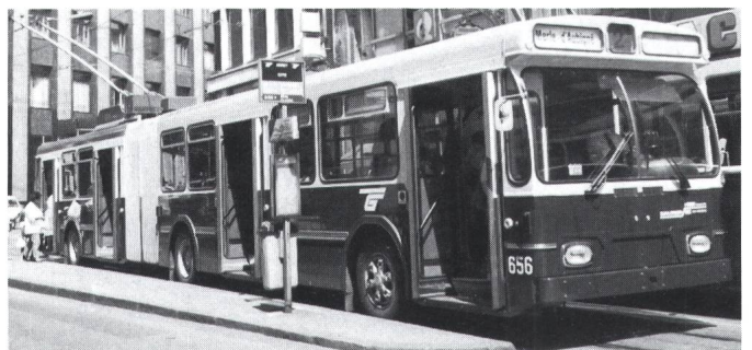
Fig. 6 Trolleybus articulé à deux essieux entraînés de Genève (Photo BBC)
