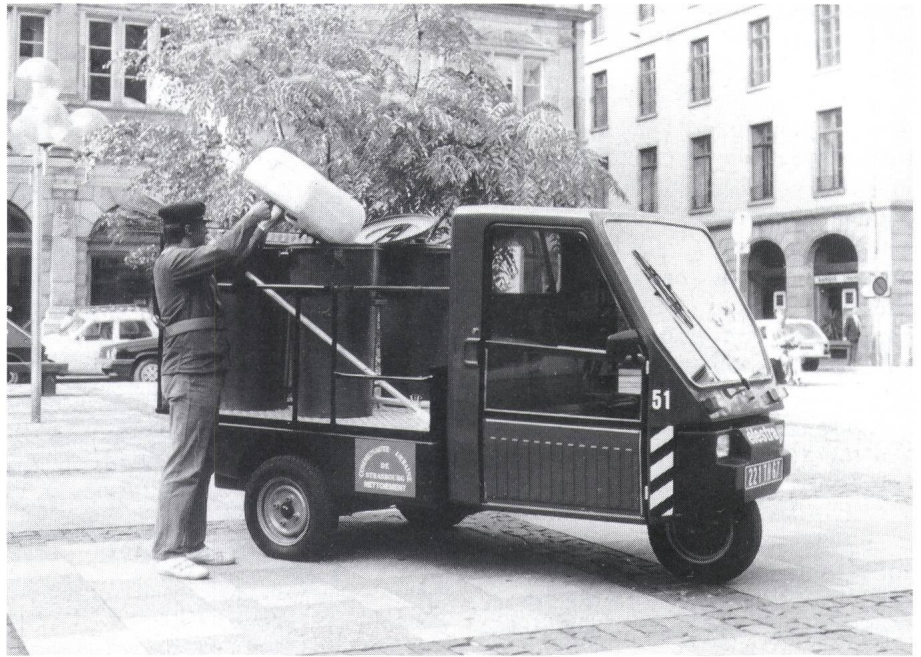
Fig. 2 Elestra avec plateau porte-poubelles en service
