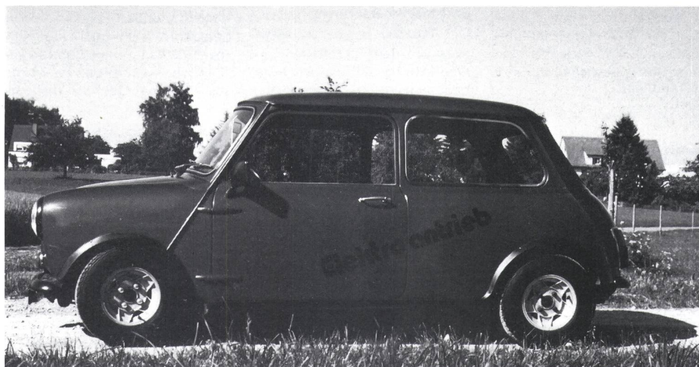
Fig. 1 Der elektrifizierte Morris Mini weist folgende technische Daten auf: Leergewicht: 900 kg / Gesamtgewicht: 1060 kg / Sitzplätze: 2 Antriebsleistung: 10 kW nominal, 20 kW maximal Batterie: 48 V/175 Ah 300 kg Norm-Traktionsbatterie mit Rekombinatoren Steuerung: elektronische Impulssteuerung mit Rekuperationsbremse Höchstgeschwindigkeit: 100 km/h / Reichweite: etwa 30-40 km Kraftübertragung: Kupplung und Original-4-Gang-Getriebe auf die Vorderräder
