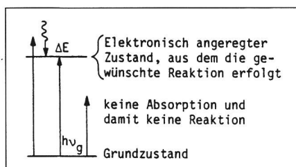
Fig. 1 Bedingung, dass nur Photonen der Energie h\nu > h\nu_g absorbiert werden und dass die Überschussenergie \Delta E = h\nu - h\nu_g in Wärme umgewandelt wird
