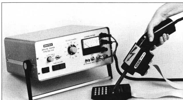
Type PSD 15A für die Simulation von Entladungen statischer Energie bis 15 kV
