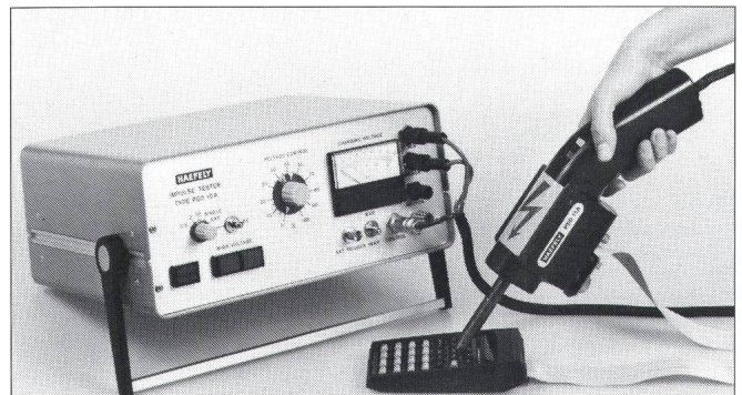
Type PSD 15A für die Simulation von Entladungen statischer Energie bis 15 kV
