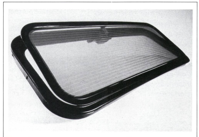
Figur 12 Sonnendach als Dünnschicht-Generator für ein Autodach zum Antrieb eines Belüf- tungsventilators
